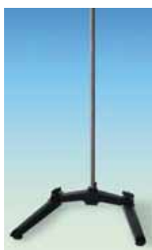
Штатив ST200 стойка Ф23 * h1200мм, основание 34*75 см
