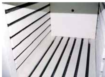
Внутренняя камера моделей FH (1200 °С)
