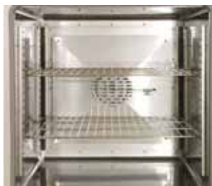
Камера сушильного шкафа с вентилятором принудительной конвекции
